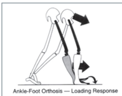
Figuur 4: Effect van een rigide EVO met enkelfixatie op knieflexie tijdens gewichtname.
