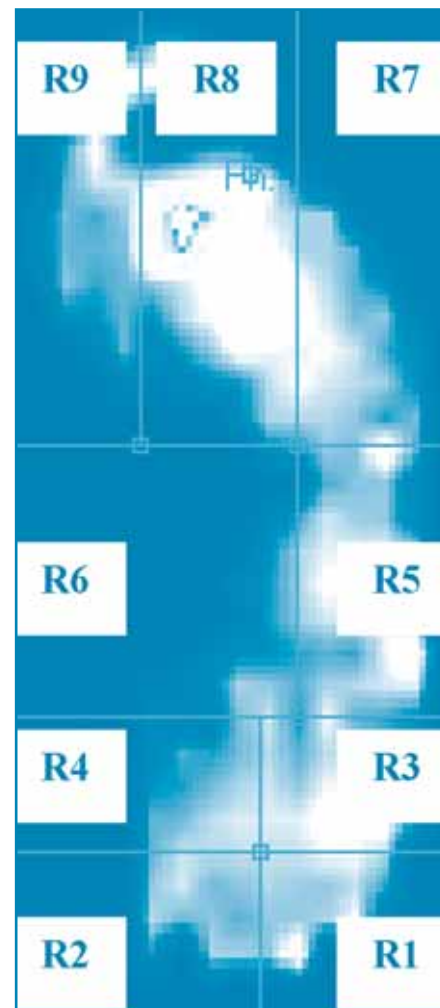
Figuur 2: Meetgebieden (zgn "masks") R1 t/m R9 onder de voet gebruikt voor de drukanalyse
