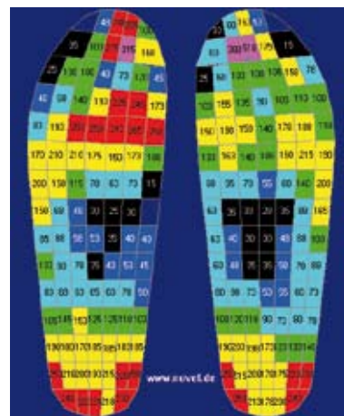
Figuur 1: Drukmeetzooltjes beschikbaar in verschillende maten (links) en een drukmeetdiagram met warme kleuren die hogere drukken weergeven.
