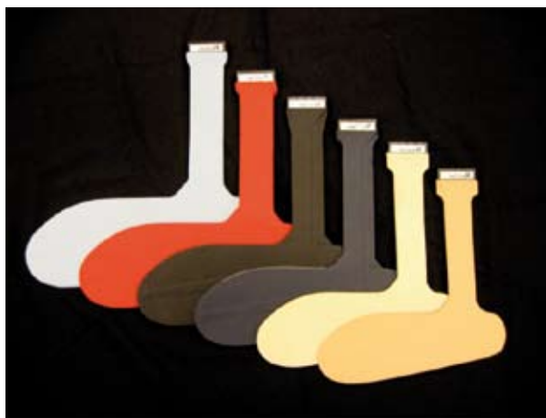
Figuur 1: Drukmeetzooltjes beschikbaar in verschillende maten (links) en een drukmeetdiagram met warme kleuren die hogere drukken weergeven.
